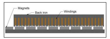
Fig. 5: Ironcore linear motor
