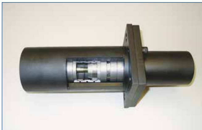
Schnittmodell Industriepuffer / Cross section of industrial buffer
